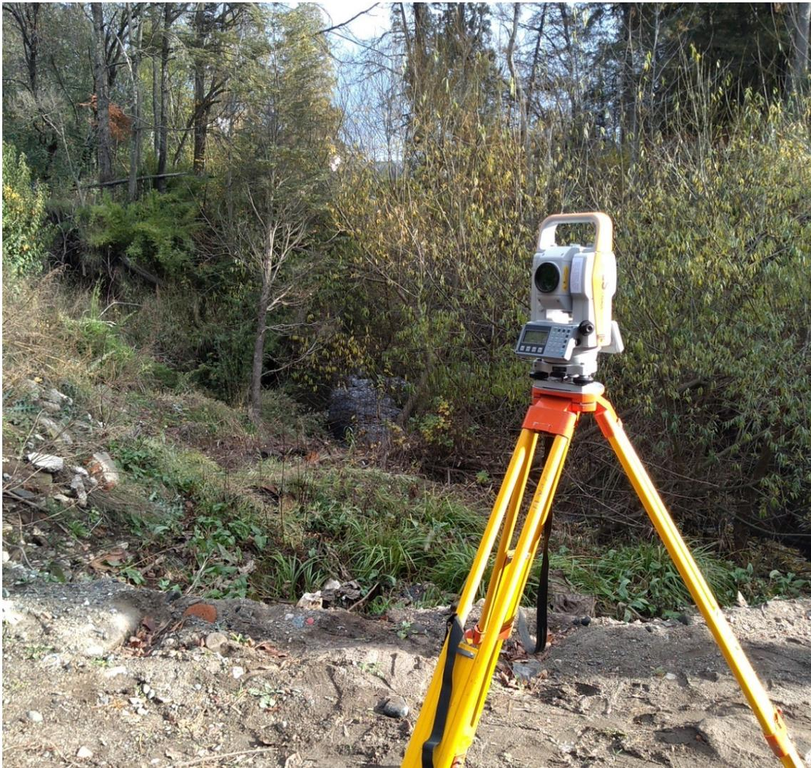
Imagen – Levantamiento con Estación Total
