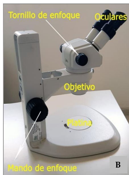
B) Partes lupa binocular
