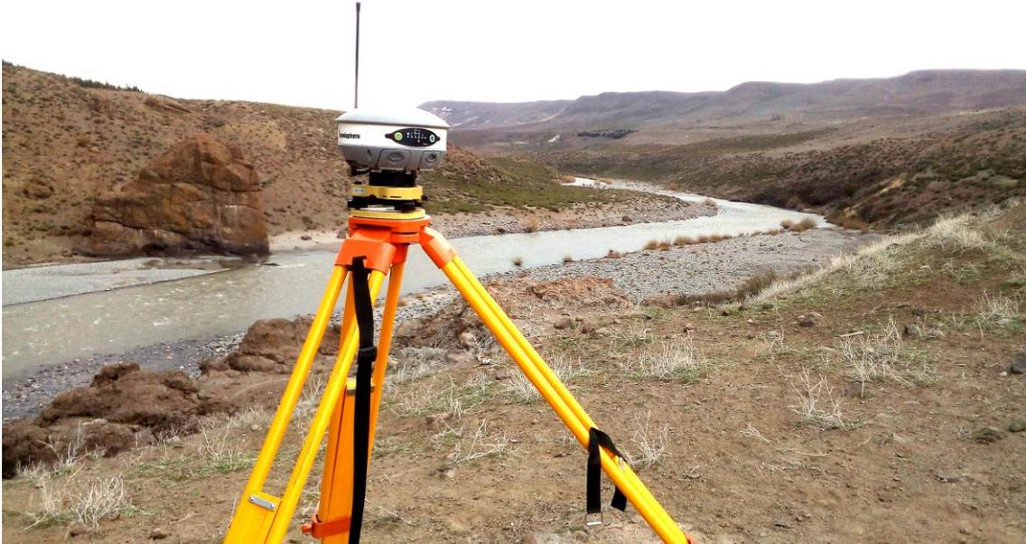
*Imagen N° 1 - GPS Hemisphere S320 sobre el punto de Estación*
