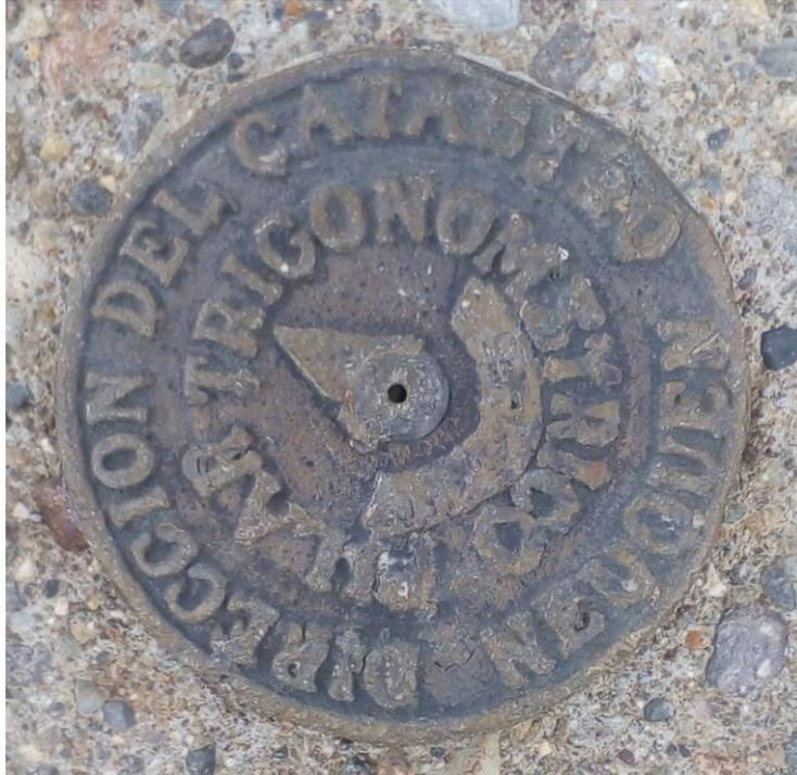
*Imagen N° 4 - Pilar trigonométrico*
