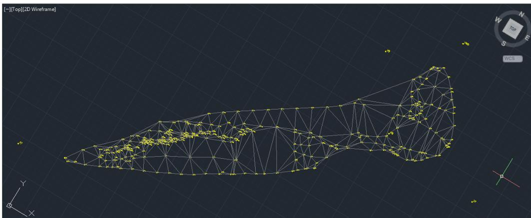
*Imagen N° 6 - Triangulación generada por CivilCAD*
