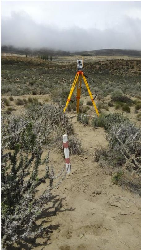
En la imagen se puede apreciar el instrumento midiendo a la estaca que marca el norte magnético en concordancia con el punto de estación.
